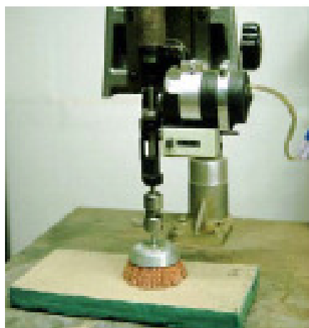
Fig. D23-16: PLASTER + material abrasion test
