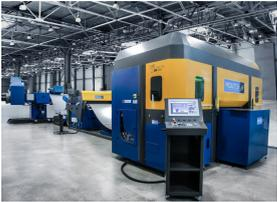
Una máquina de troquelado con láser optimiza el uso de materias primas, el tiempo de fabricación y el espacio de almacén
