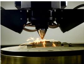
La technologie de fusion par faisceau d'électrons prend de la hauteur
