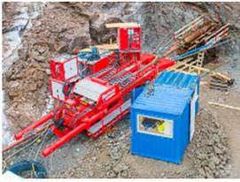
La foreuse à roche orientable qui creuse en montée et dans les courbes
