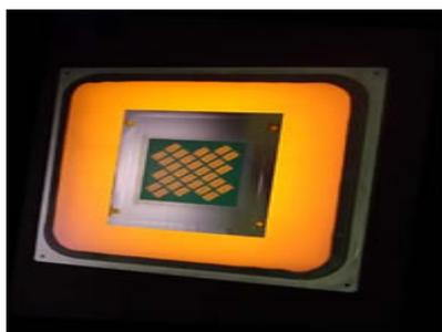
L'elaborazione a film spesso ha costituito la tecnica principale e la più efficace per la produzione di circuiti stampati integrati. Oggi, le nuove tecnologie come il modulo multichip (MCM) richiedono la presenza, sul microcircuito, di un numero molto più elevato di interconnessioni, per ottenere le quali è necessario ricorrere ad una tecnologia di
