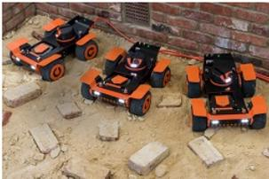
Robot per l'applicazione degli strati di isolamento a pavimento aumentano l'efficienza energetica
