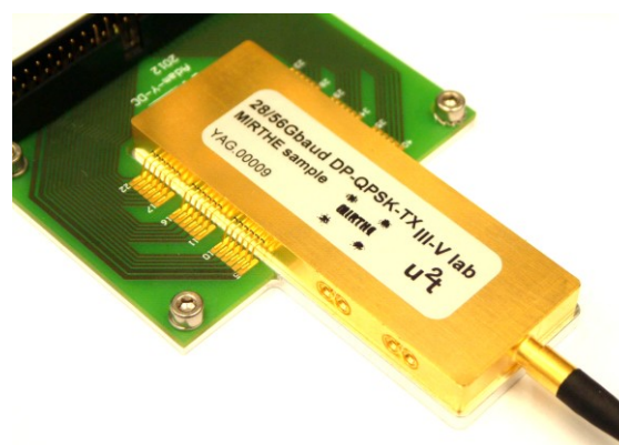
Assembled 28Gbaud DP-Tx module
