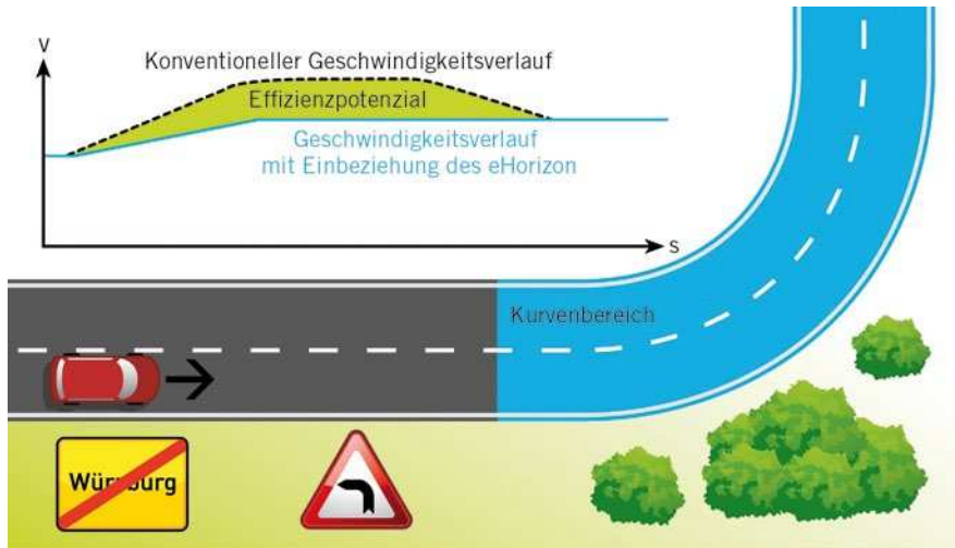
③ Die neue Funktion des eHorizon erlaubt es, unnötiges Beschleunigen zu vermeiden, falls der Straßenverlauf dies nahelegt
