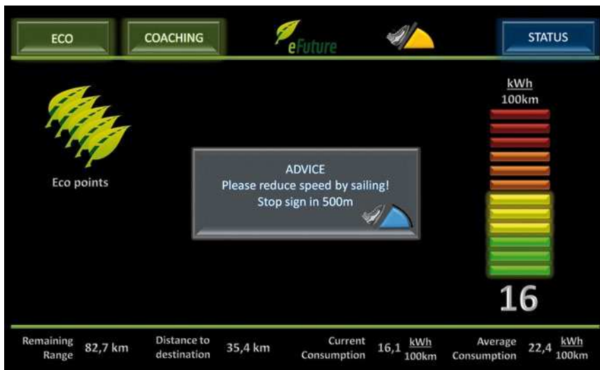
4 Displaykonzept für Fahrermeldungen zur Energieeffizienz
