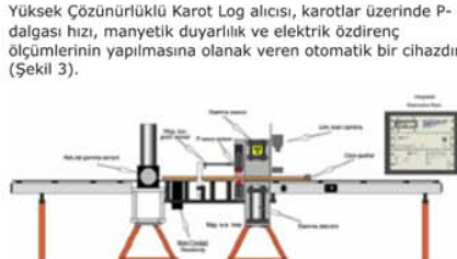
Şekil 3. Yüksek çözünürlüklü Karot Log Alıcısı.
