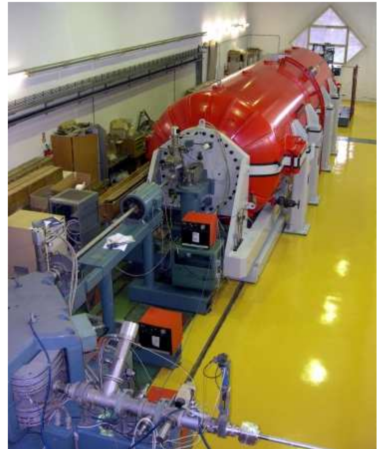
6.0 MV EN Tandem Van de Graaff accelerator
