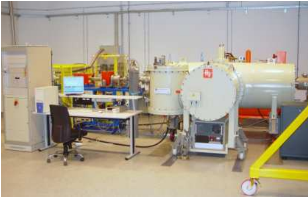
1.0 MV HVE Tandetron accelerator
