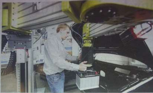
Der Roboterarm des Liebherr übernimmt die Last: Er hebt die Aufbauteile an. So kann ein Mitarbeiter im Fahrzeug einsteigen, ohne selbst das Gewicht zu spüren zu bekommen. Felix Wiedner
