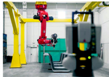
Aspecto de la infraestructura de Megarob en la sede de Aitiip, en Zaragoza en primer plano, el 'laser tracker' que ayuda a hacer más preciso el trabajo del robot montado sobre un puente grúa.
