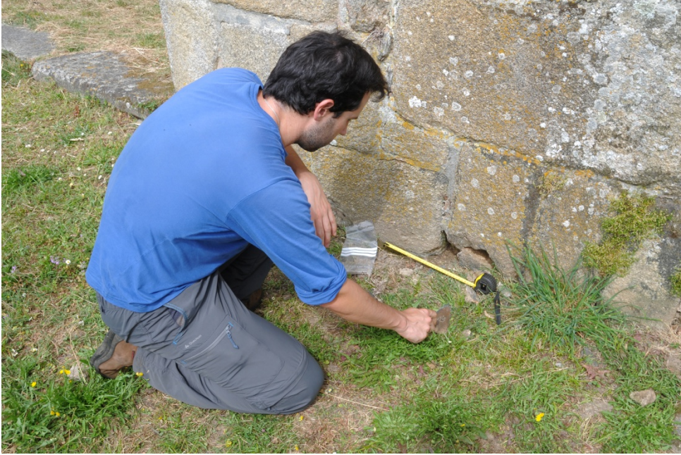
Mortar sampling at Panxón (Nigrán)
