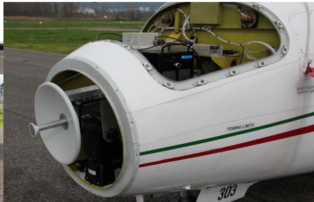
Radar installation onboard the Piaggio P-166.
