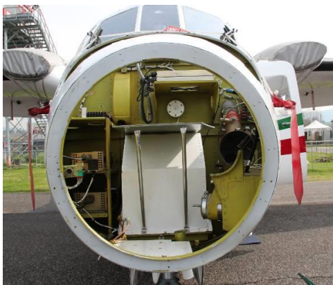
Radar installation onboard the Piaggio P-166.
